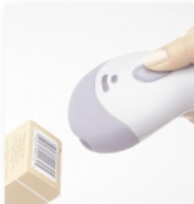
CodeGate trabaja codo a codo con el sistema de disparo automático patentado por Metrologic. Simplemente hay que colocar un código de barras frente al escáner y el láser de 650 nanómetros y alta visibilidad se activa automáticamente, lo que permite al usuario seleccionar de modo sencillo el código de barras que se desea explorar. Pulse el botón CodeGate y los datos se transmitirán al sistema anfitrión.
